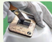
塗膜に1~2mm間隔の格子状切り込みをいれる塗膜密着性確認(クロスカット)試験を実施しています。
